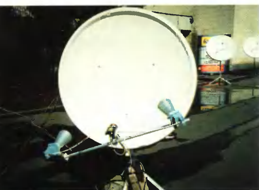
Многолучевая антенная система спутникового телевидения
